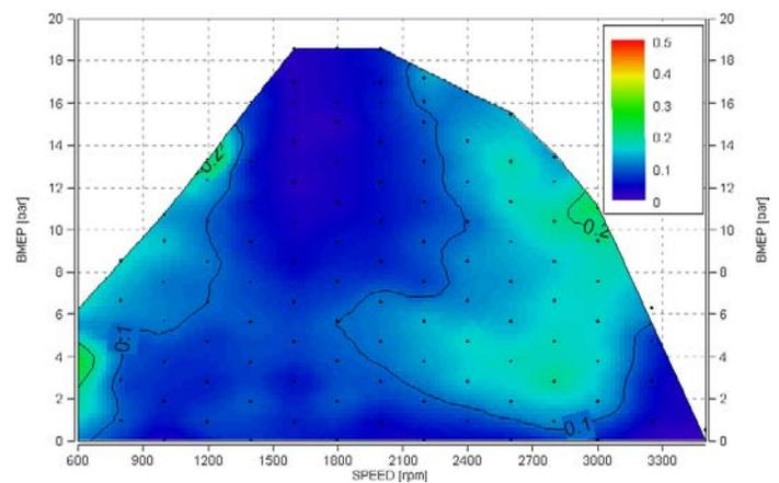
Figure 18 – Exhaust Smoke (Bosch) on JP-8
